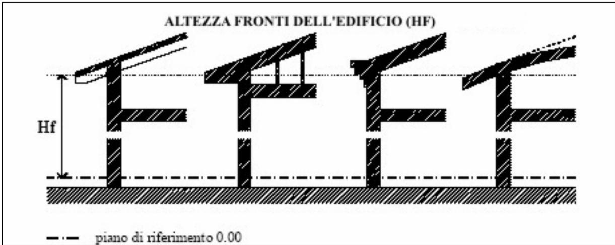
Nel caso la pendenza della falda superi il 35% o la lunghezza del cornicione superi m.1,20 dalla parete verticale, l'altezza va misurata ai due terzi della lunghezza della relativa falda, a partire dalla linea di gronda.
