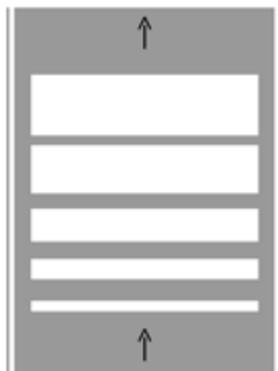
Sulla base delle indicazioni progettuali ovvero della Direzione Lavori, i sistemi di rallentamento ad **effetto acustico** saranno realizzati mediante irruvidimento della pavimentazione stradale ottenuta con la scarificazione o incisione superficiale della stessa o con l'applicazione di strati sottili di materiale in rilievo in aderenza, eventualmente integrato con dispositivi rifrangenti. Tali dispositivi possono anche determinare effetti vibratorio di limitata intensità.
