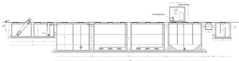
Dettaglio depuratore tipo "OXI-PE900/Integrato": sezione AA
